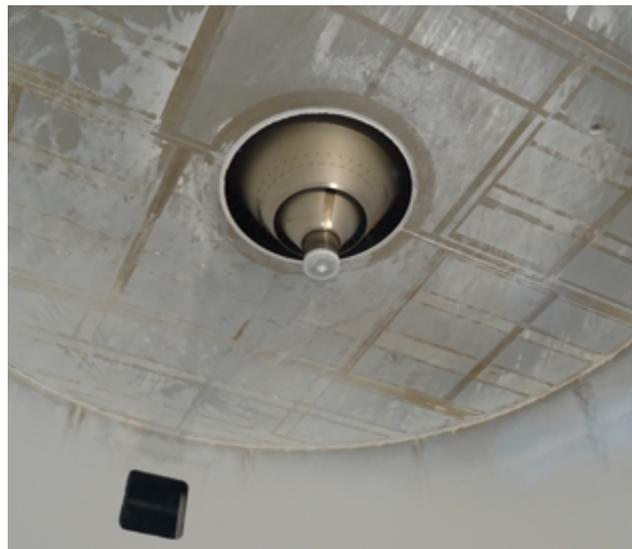
Blick auf die im Trockenturm eingebaute Zerstäubereinheit.
