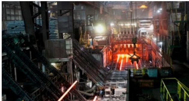
Dank der neuartigen Verfahrenskombination kann die ESF heute etwa 75 % der aus dem Stahlwerk austretenden heißen Knüppel direkt im Walzwerk verarbeiten.
