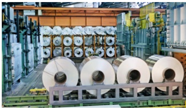
Mit einem Chargierwagen werden jeweils vier Coils in die neue Ofenanlage eingebracht.
