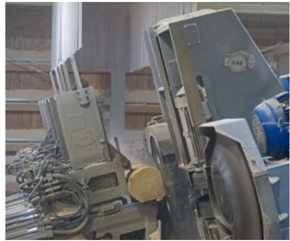
Die Vertikalsäge ist ein Teil der neuen material- und energiesparenden Sägetechnik.
