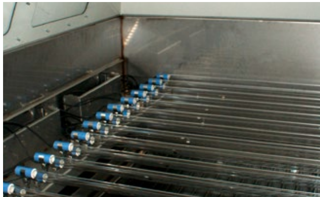
Bestrahlung mit UV-Licht neutralisiert Geruch und sorgt für gute Luft.
